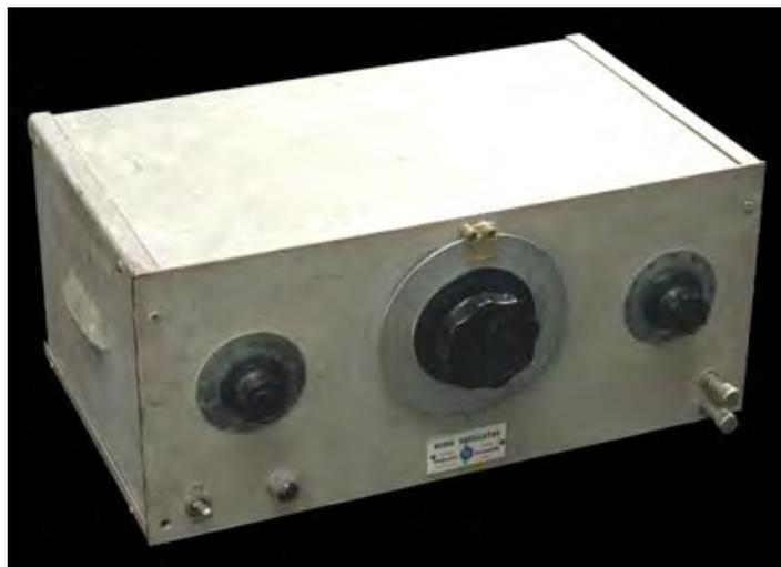
**Figura 2.** Primer producto comercial de HP, el oscilador de audio 200A de 1939 [3].
