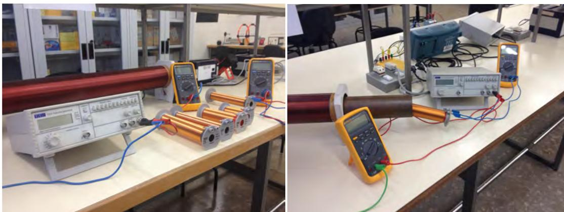
Fig. 1. (a) Solenoide grandes, solenoides pequeños, amperímetro, voltímetro y generador de tensiones sinusoidales en el tiempo. (b) Solenoide pequeño parcialmente introducido en un tubo metálico que a su vez se introduce en un solenoide grande para la medida del apantallamiento magnético.
