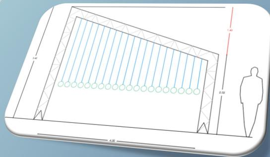
Se ha diseñado el montaje de forma que la longitud del péndulo más corto sea de 0,99m, lo que hace que el periodo sea 2 s, es decir, en 120 s, realizará 60 oscilaciones completas. Nuestro montaje consta de quince péndulos desacoplados con la misma masa y longitudes que aumentan monótonamente.
