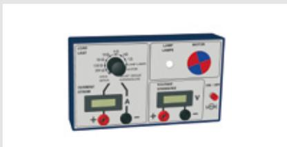
La caja de mediciones de carga para registrar los datos se utiliza para experimentos avanzados. Aparatos consumidores de energía como un motor, una lámpara y 7 resistencias seleccionables, hacen posibles numerosos experimentos, por ejemplo registro de curvas características ó intensidad y tensión.
